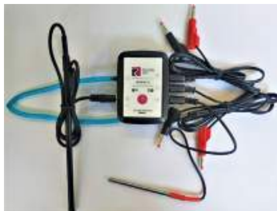
Рис. 9. Беспроводной мультидатчик Releon Air «Физика-5»
